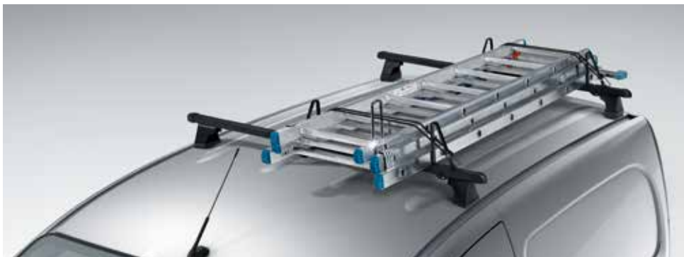
Ladderhouder 1 . Opzetstuk voor veilig transport van ladders op de basisdragers. Eenvoudige en snelle montage. Geschikt voor alle “basisdragers Standaard” met een dwarsbuisdiameter van 20 x 30 mm en 30 x 30 mm.
